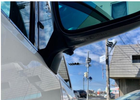
ドアミラー本体に、たくさんの配線が通っている場合など配線が行いにくい車両ではドアミラーの土台を取り外して24mmの穴を開けて取り付けてください。
