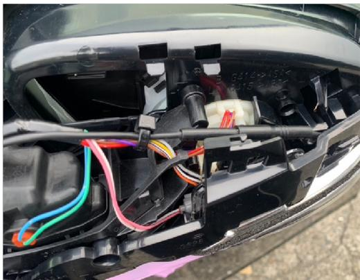
カメラのケーブルと、メインのサイドカメラケーブルの間には延長ハーネスを使用してください。延長ハーネスを使用することによりドアミラーモーター内の配線が通しやすくなります。
