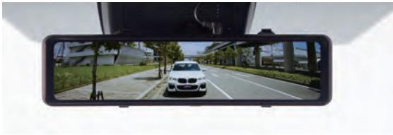
カメラ表示モードで、ボタンをタッチすると、フロントカメラ表示とリアカメラ表示前後2画面表示を切り替えます。
